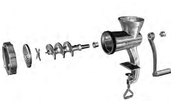
شکل ۶۷- تصویر سه بعدی انفجاری چرخ‌گوشت دستی
