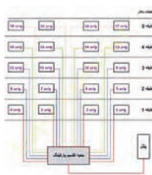
الف- نقشه سیم‌کشی درب‌بازکن
