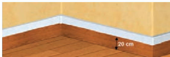
شکل ۵۲ - فاصله داکت یا ترانک از کف
