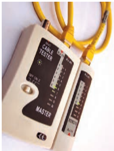
شکل ۲۰- تست کابل شبکه
