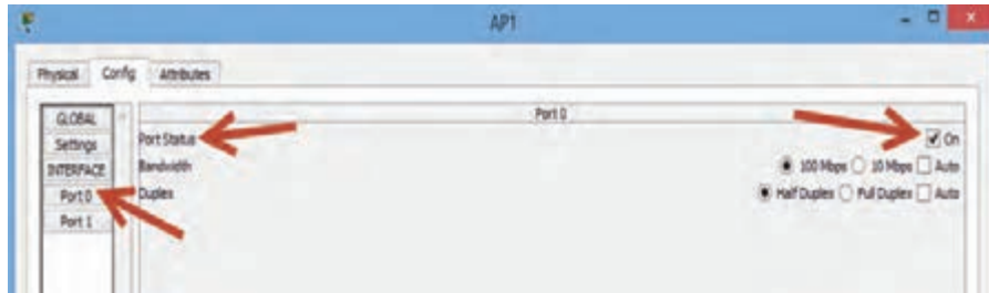
شکل ۲۶- وضعیت port0 در AP
