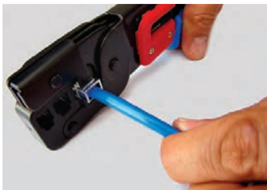
شکل ۲۹- پرس کردن سوکت RJ45
