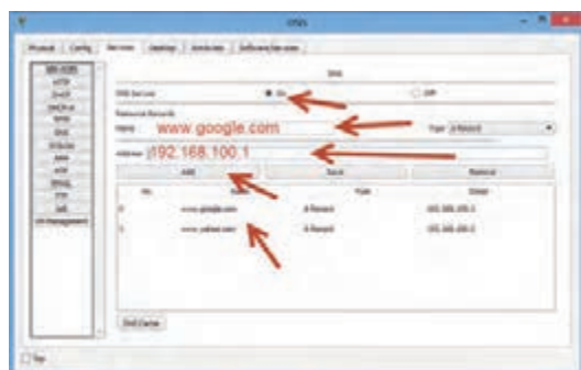
شکل ۴۰ – تنظیمات DNS Server
