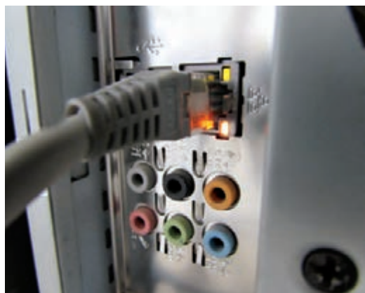
شکل ۴۳- چراغ‌های کارت شبکه
