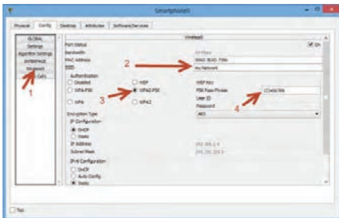
شکل ۲۴- تنظیمات اتصال بی سیم گوشی هوشمند و تبلت
