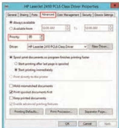
شکل ۵۹- تعیین اولویت چاپگر
