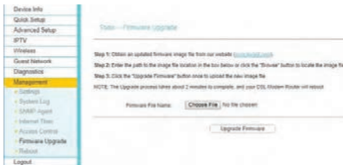
شکل ۶۱- به‌روزرسانی Firmware مودم
