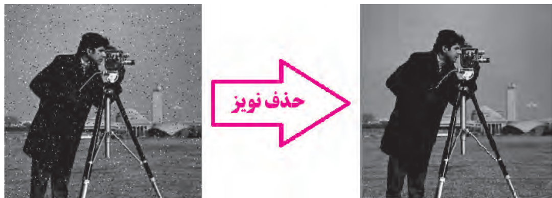
شکل ۱۴- کاربرد پردازش تصویر سطح پایین در حذف نویز تصویر
