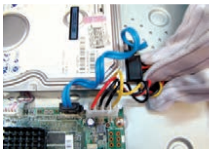
شکل ۳۴- اتصال کابل تغذیه دیسک سخت
