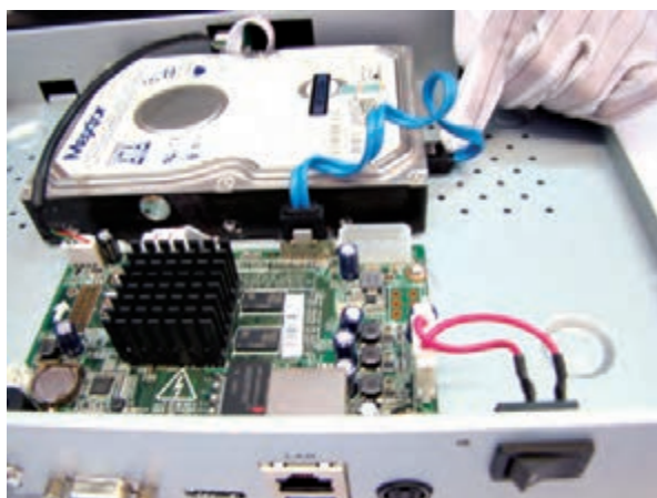
شکل ۳۳- اتصال کابل داده دیسک سخت
