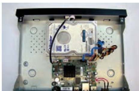
شکل ۳۵- محکم کردن دیسک سخت در محل نصب
