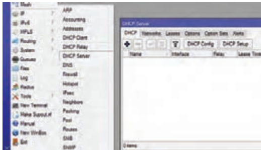
شکل ۳۲- مسیر دسترسی به تنظیمات DHCP Server
