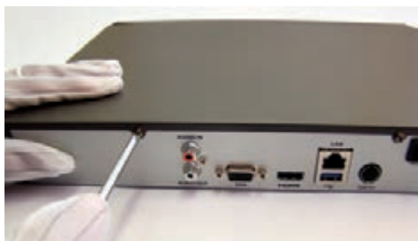
شکل ۳۲- بازکردن درپوش NVR
