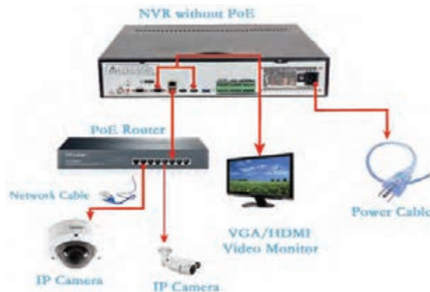
شکل ۱۷- اتصال دوربین به NVR
