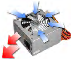
شکل ۲۳- جهت تهویه هوا در منبع تغذیه
