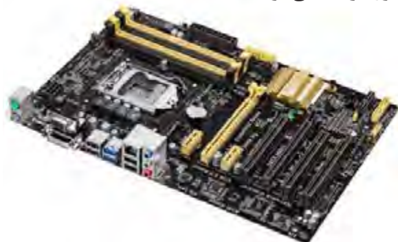
شکل ۸ - برد اصلی با فرم فاکتور ATX
