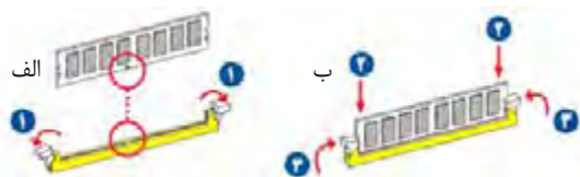
شکل ۴۰- مراحل نصب ماژول حافظه
